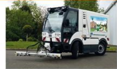
Mise en place d'une laveuse 1900 L nettoyeuse décapeuse à eau chaude pour le lavage des places et espaces publics
